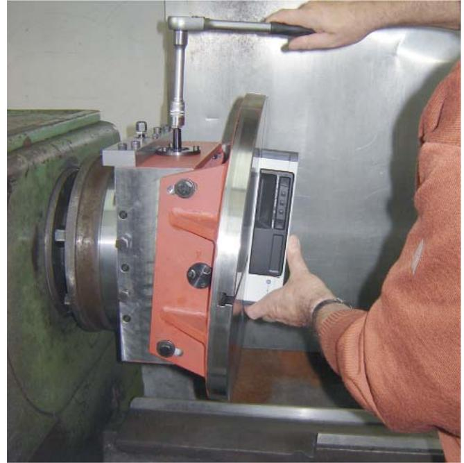
Einstellung des Neigungswinkels mit digitalem Winkelmessgerät
