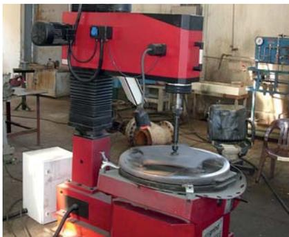
STM 800 E Schleifen eines Schieberkeils
